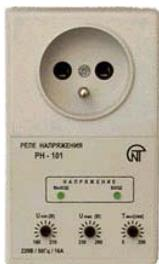
Реле напряжения **РН-101** является, по сути, самостоятельным коммутационным аппаратом. Включается непосредственно в сетевую розетку, а нагрузка включается в розеточный разъем реле. Защищает нагрузку мощностью до 3,5 кВт (до 16 А) от недопустимых колебаний напряжения в сети. Имеет три независимые регулировки:
