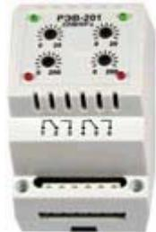
Электронное двухканальное реле времени с задержкой на включение **РЭВ-201** предназначено для коммутации электрических сетей переменного тока 220В/50Гц и постоянного тока 24-100 В с регулируемой задержкой времени от 0 до 220 сек. Каждый канал является самостоятельным реле времени. Реле РЭВ-201 позволяет обеспечить три режима работы:
